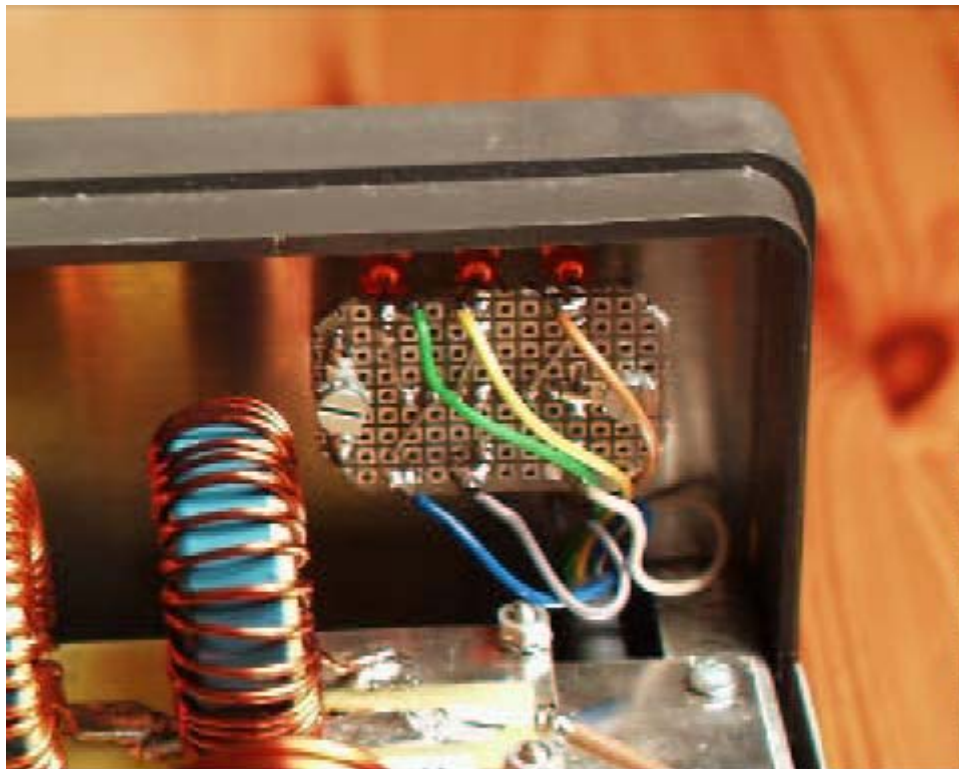
Sisäkuva suodinpankista – näkyvissä LED-platta
